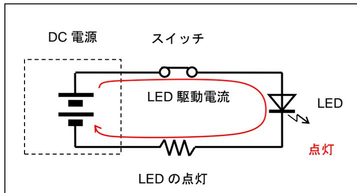
このようにスイッチを操作することで、LED に電流を流すことで、LED を点灯させることができます。
