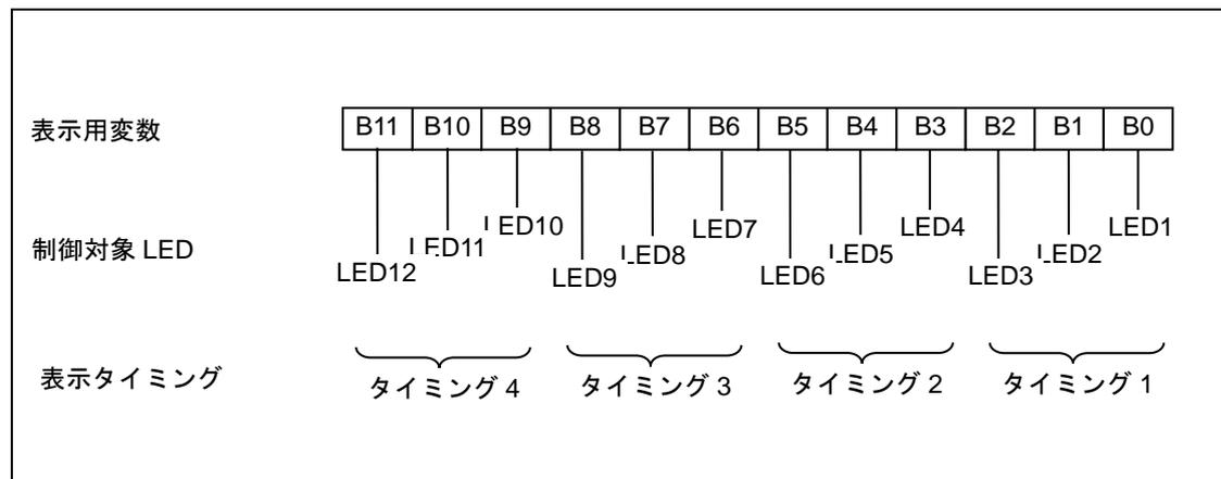
ここでは LED 表示データ用に 16 ビットの変数 G\_LED\_DATA を定義し、各ビットを上記のように定義しておきます。
