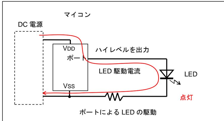
ポートをロウレベルに設定すると、LEDのアノードには十分な電圧がかからなくなります。そのため、電流が流れなくなり、LEDは点灯しません。
