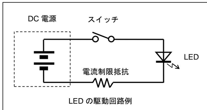
スイッチを閉じると電流の流れる経路が構成され、LED に電流が流れて点灯します。
