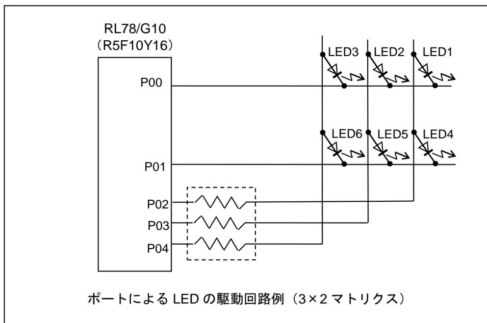
この回路例では、P02にハイレベルを出力し、P00にロウレベルを出力すると、LED1には電流が流れるので、LED1が点灯します。P03にハイレベルを出力し、P00にロウレベルを出力すると、LED2が点灯します。
