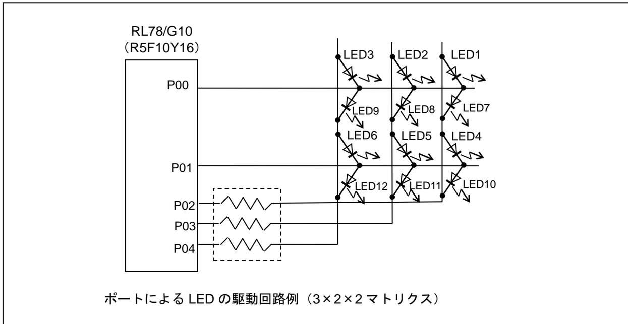
上記回路が 5 本のポートで 12 個の LED を制御する回路です。回路自体は LED を逆向きに追加しただけと単純な回路です。
