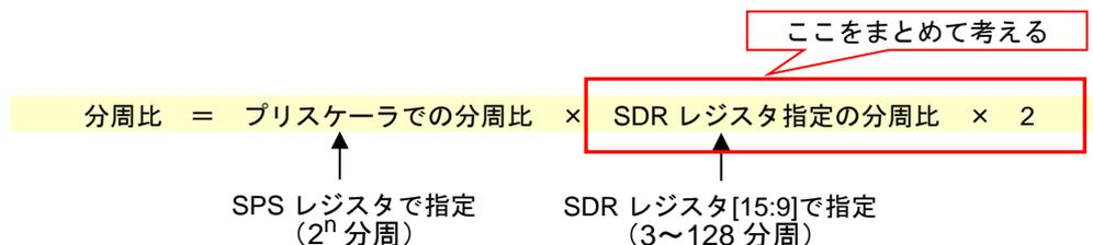
必要な分周比から、SDR レジスタ以降での分周比が 256 以下になるようにプリスケアラでの分周比 (2<sup>n</sup>) を求めます。残りを SDR レジスタに設定するときの補正 (-1) と結果の四捨五入を合わせて処理します。得られた値を SPS と SDR レジスタに設定することで、ボー・レート補正が実現できます。
