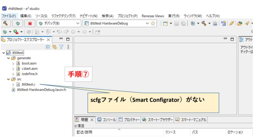
参考 RX66Tでは 作成したプロジェクトにSmart Configuratorが内装されている
