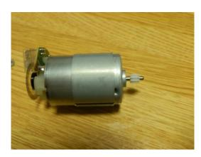
付属のピニオンギアの穴を 2.2mm 程度に大き くしてシャフトから 2mm 入れ込む。
