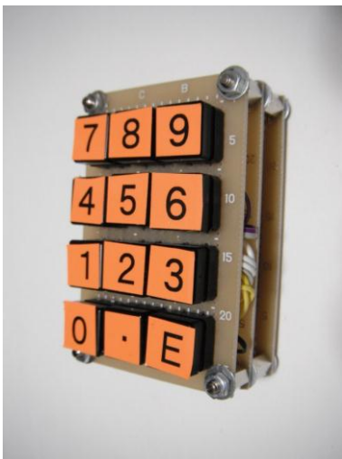
3号機。1号機を2枚の基板に別けて重ねたもの。ケース代わりに基板を追加している。右側にスイッチで右側にマイコン。半田の出来はご愛嬌をお願いします。
